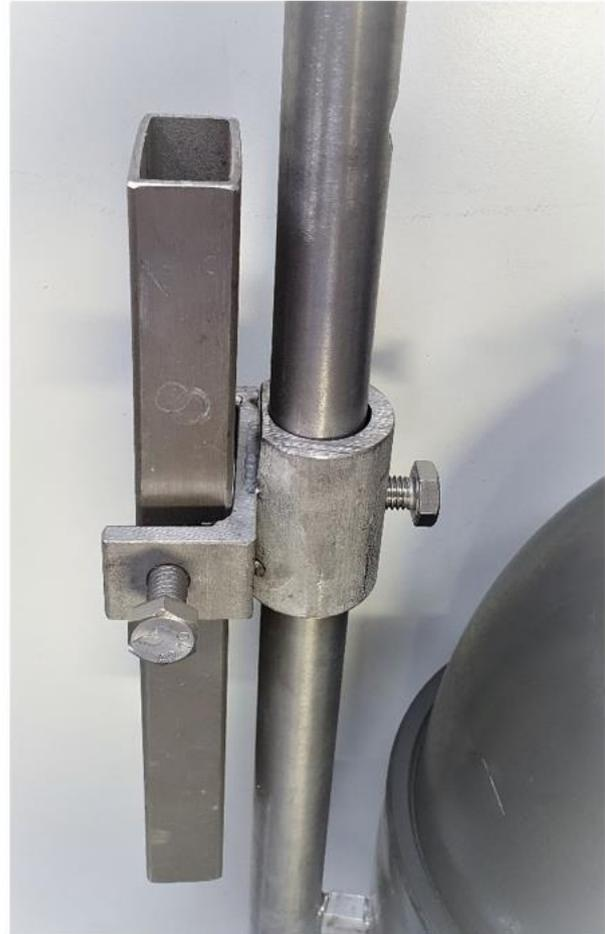
**Montage:** Auf das bereits montierte FZV30 FIX- Befestigungssystem werden die beiden Leiter-Haltewinkel aufgeschoben. Die Haltewinkel so positionieren, dass ein Halter am unteren- und der 2. Halter am oberen Ende des Rundstahls sitzt. Die Halter auf den Leiterholm ausrichten und mit beiden Schrauben sicher befestigen.
