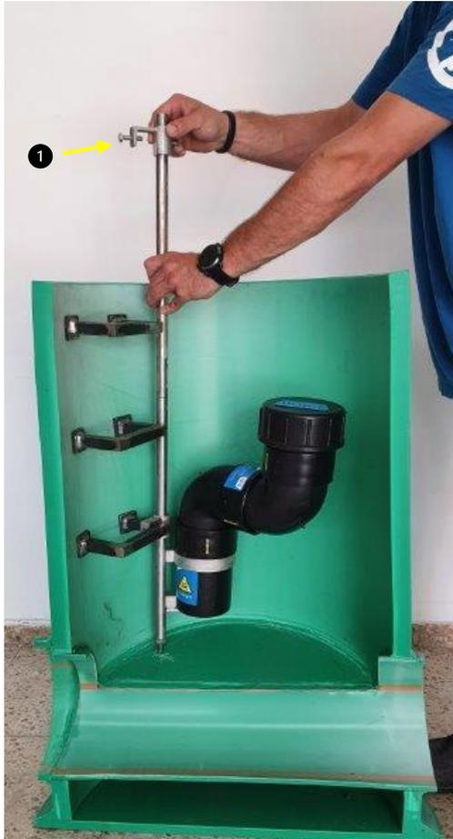
Den zweiten Steigeisenhalter ① auf das Rohr aufschieben
