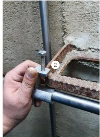
**Montage:** Der horizontale Ausleger ① wird auf dem senkrechten Rohr des Fixsystems aufgesteckt und horizontal mit dem Steigbügel mithilfe der Steigeisen Haltewinkel ② befestigt. Nach Ausrichtung der Rattenköderstation ist die horizontale Schraube am Rohr anzuziehen.
